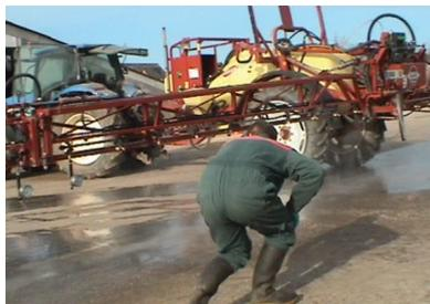
Lors du test de la rampe, l'inspecteur se place derrière la rampe en fonctionnement pour lire les pressions indiquées en sortie de buses. Des projections depuis la rampe de pulvérisation peuvent amener une contamination respiratoire et du corps entier.
